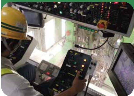
マクラギの沈下によりレールの歪みが生じるので、そのメンテナンスのために専用の特殊保線車両(MTT:マルチプルタイタンパー)を使用して道床(砂利)の突固めを行います。オペレーターはJRの特殊な資格を要し、研修施設で短期~長期(1年)にかけて資格取得可能です。
